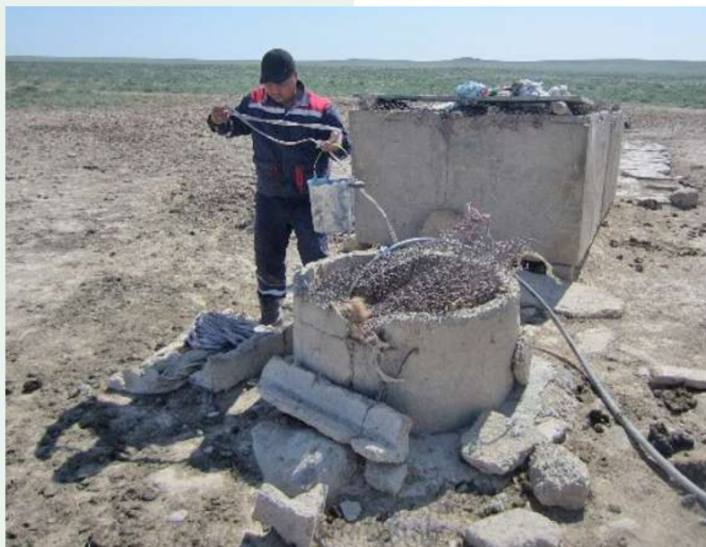
Рисунок 2 – Отбор проб природной воды из колодца (район рудника «Уванас») / Figure 2 - Sampling of natural water from a well (Uvanas mine area)
