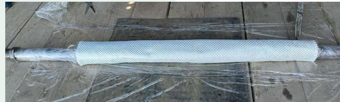
Рисунок 3 – Подготовленный к спуску в скважину пакер / Figure 3 - Packer prepared for running into the well
