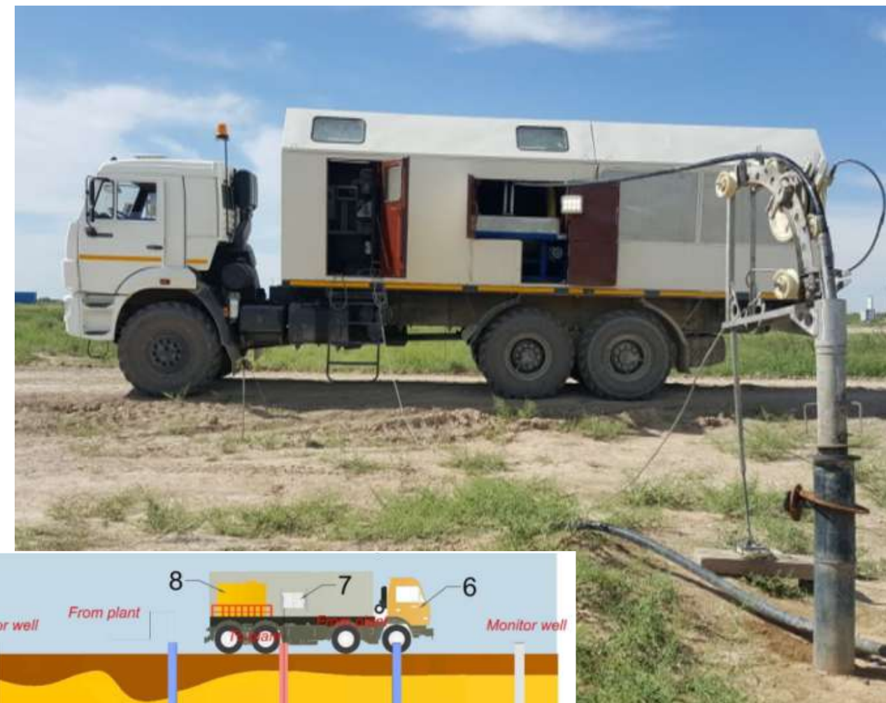
1-сурет – Технологиялық ұңғымаларды химиялық өңдеуге арналған жылжымалы қондырғы
