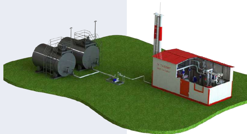
Рис. 1. Схема котельной с резервным дизельным топливом Fig. 1 Diagram of a boiler house with reserve diesel fuel
