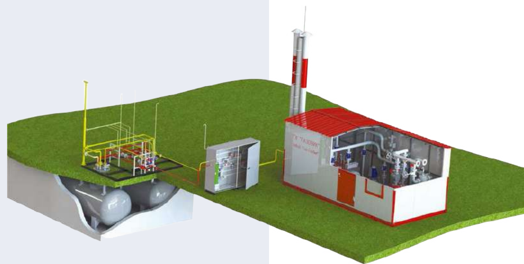
Рис. 2. Схема котельной с резервом топлива СУГ Fig. 2 Diagram of a boiler room with a reserve of LPG fuel
