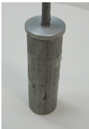
Рисунок 1. Конструктивная схема контейнера для облучения образцов
