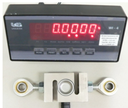
Рисунок 2. Измерительные приборы, используемые в установке «КОРИНА-2»: а - датчик перемещения; б - динамометр ДОР-3-2И
