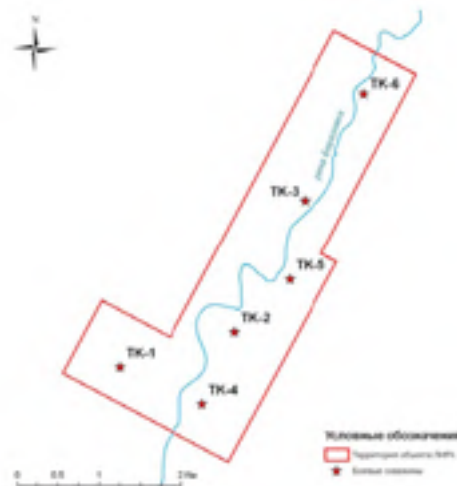
1 сурет. «ЛИРА» объектілерінде әскери ұңғымалардың орналасу сұлбасы
