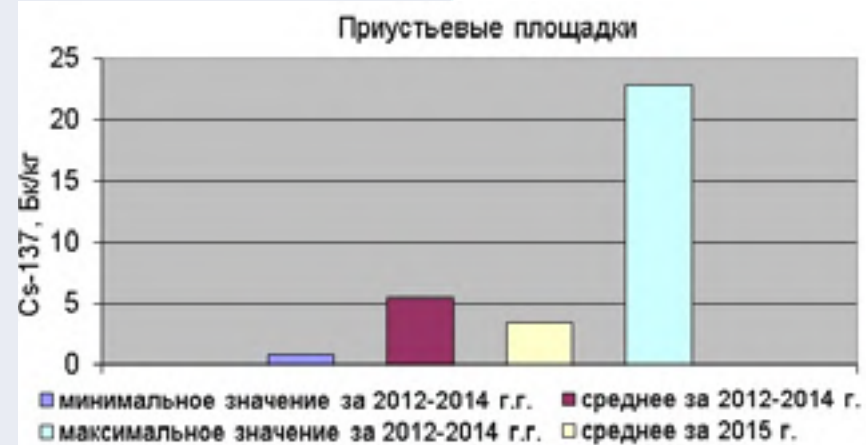
Рисунок 2. Усредненные результаты измерений удельной активности Cs-137 в пробах грунта на приустьевых площадках объектов ЛИРА за 2015 год и за контрольный период наблюдений 2012-2014 гг. Figure 2. Averaged measuring results of Cs-137 specific activity in soil samples at the estuary sites of LIRA objects for 2015 and for the monitoring period from 2012 to 2014.
