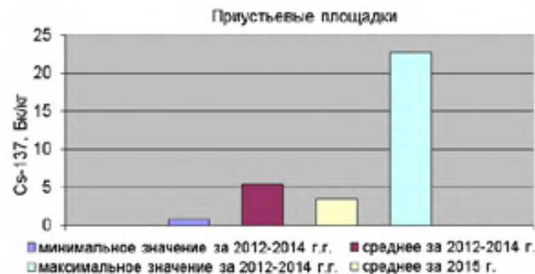
2 сурет. ЛИРА объектілерінің сағаманы алаңдарындағы топырақ үлгілеріндегі Cs-137 меншікті белсенділігін өлшеудің орташа нәтижелері, 2015 жыл және 2012-2014 жж. бақылау кезеңдері үшін
