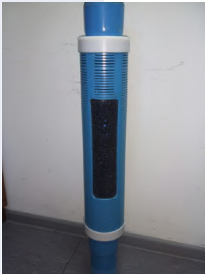
Рис.2. Предлагаемая конструкция фильтра с различной обсыпкой в кожухе Figure 2. Proposed design of the filter with different filling in the casing
