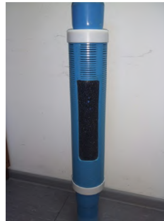
2-сурет. Қаптамасында әртүрлі себінді бар әмбебап саңылаулы сүзгінің ұсынылып отырған құрылымы (конструкция).
