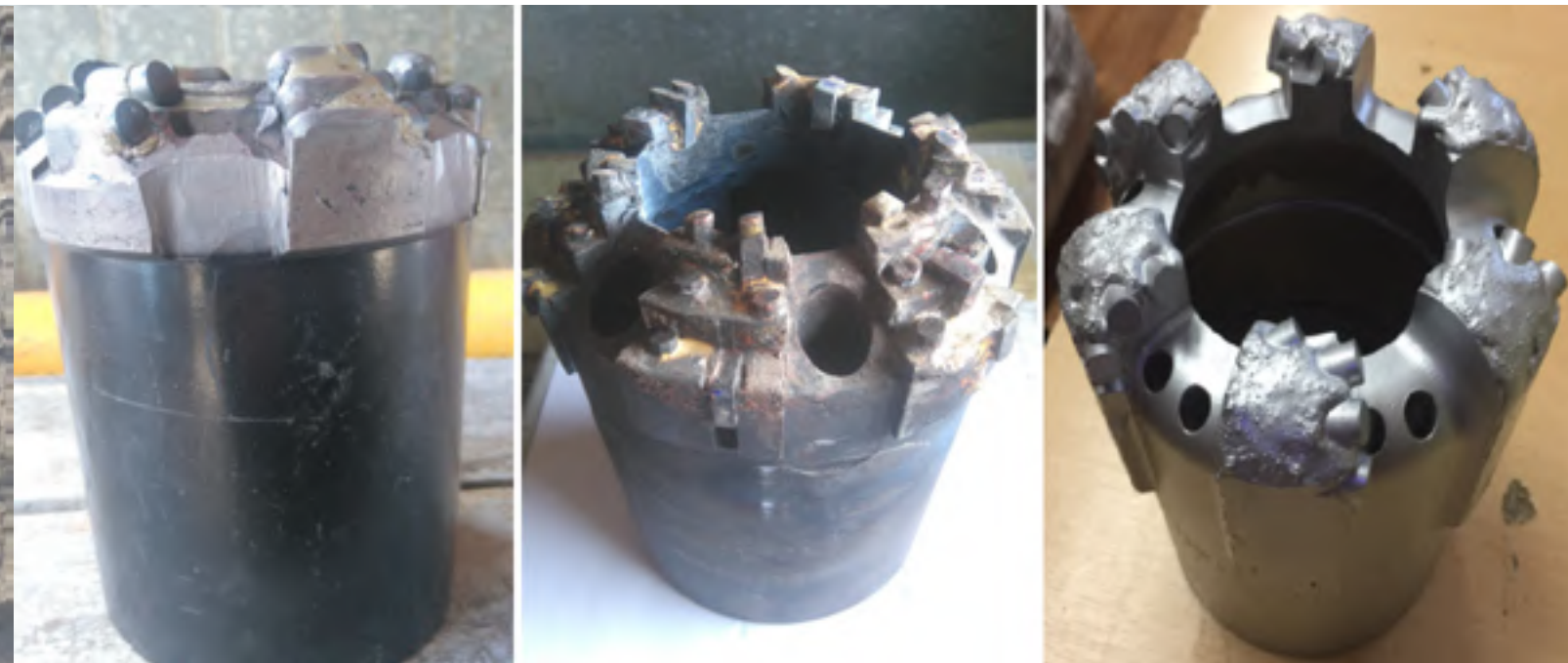
Рис.2. Породоразрушающий инструмент для ДКН / Fig.2. Rock destruction tool for DKN а) коронка PDC \varnothing 117 мм / drill bit PDC \varnothing 117 mm; б) твердосплавная коронка \varnothing 117 мм / hard-alloy bit \varnothing 117 mm; в) коронка PDC \varnothing 132 мм / bit PDC \varnothing 132 mm
