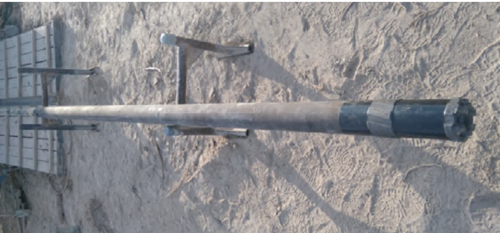
Рис.1. Двойной колонковый набор ДКН – 108/73 Figure 1. Core retrieving barrel DKN 108/73
