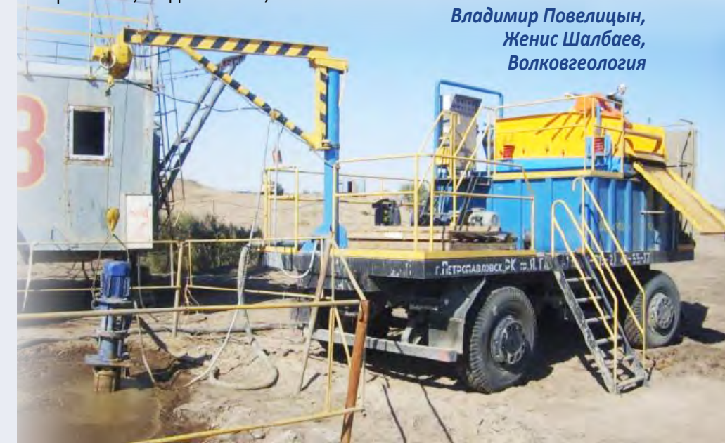
фото. Мобильный блок очистки бурового раствора от выбуренного шлама
