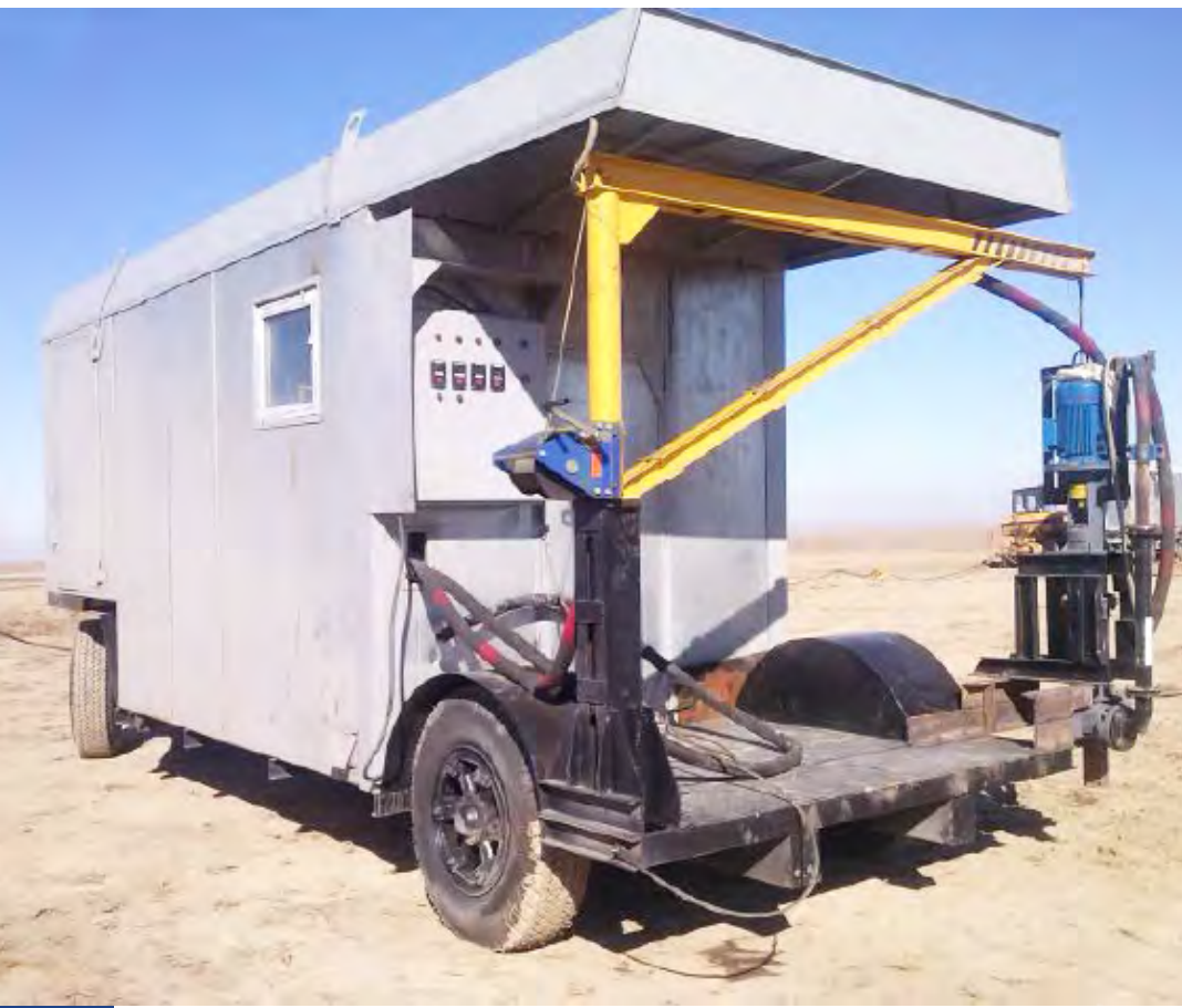
Сурет. Бұрғылау ерітінділерін тазалау мен қайта арналған қондырғы
