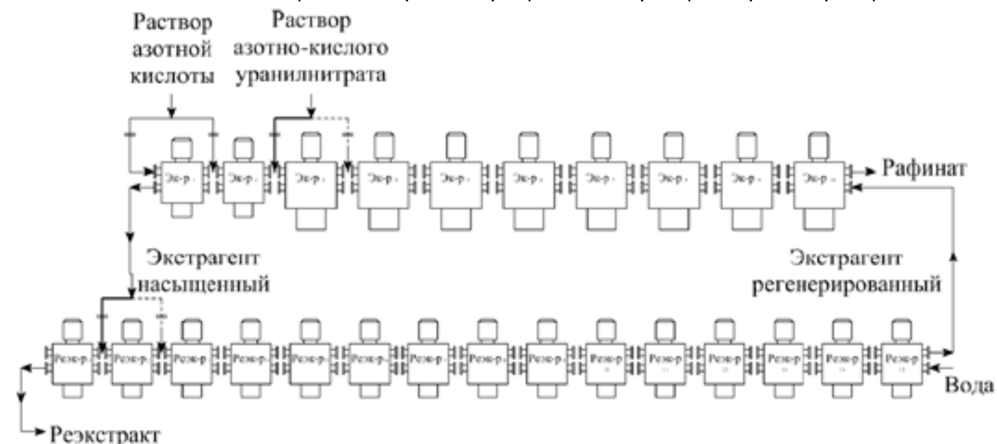
Схема обвязки цепи аппаратов процесса экстракции и реэкстракции
