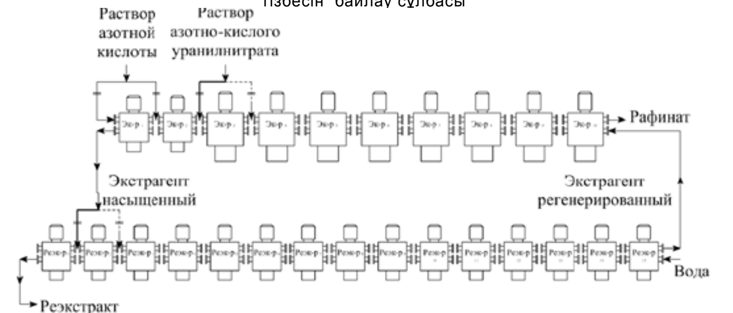
Экстракция және реэкстракция үдерісінің аппараттар тізбесін байлау сұлбасы
