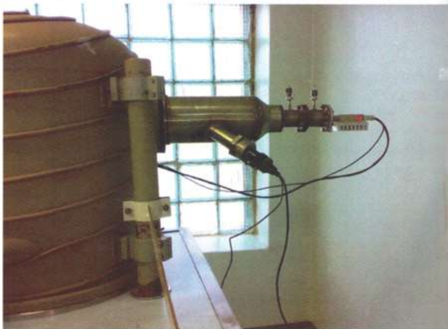
Рис. 2. Имитационная установка с макетом канала рентгеновского спектрометра
