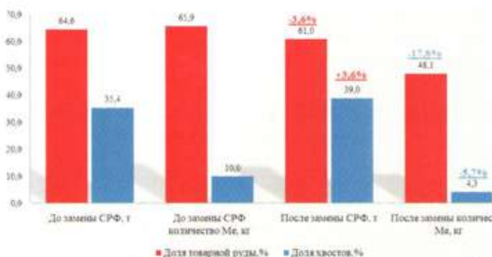
Рис. 3 Соотношение продуктов обогащения до (2009г.) и после (2010г.) реконструкции сепараторов, %.
