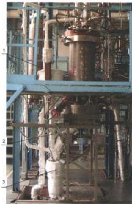
Рис. 1. Установка EAGLE для изучения процессов перемещения расплава: 1 – ловушка расплава, 2 – труба-имитатор, 3 – емкость приема расплава топлива.
