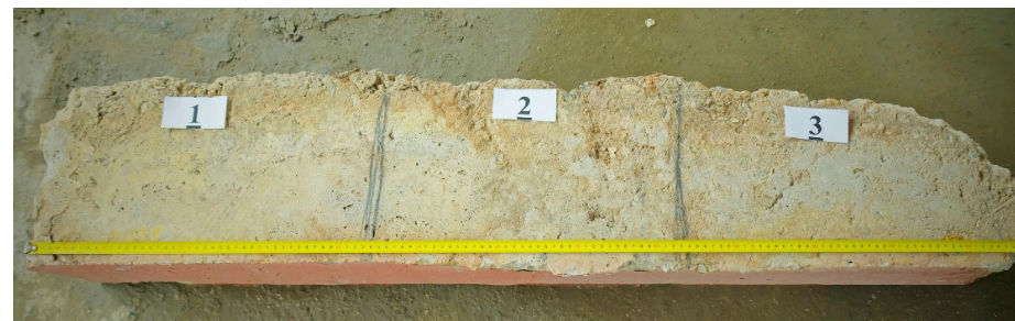
Рисунок 3. Дезактивация образцов гидродинамической машиной
