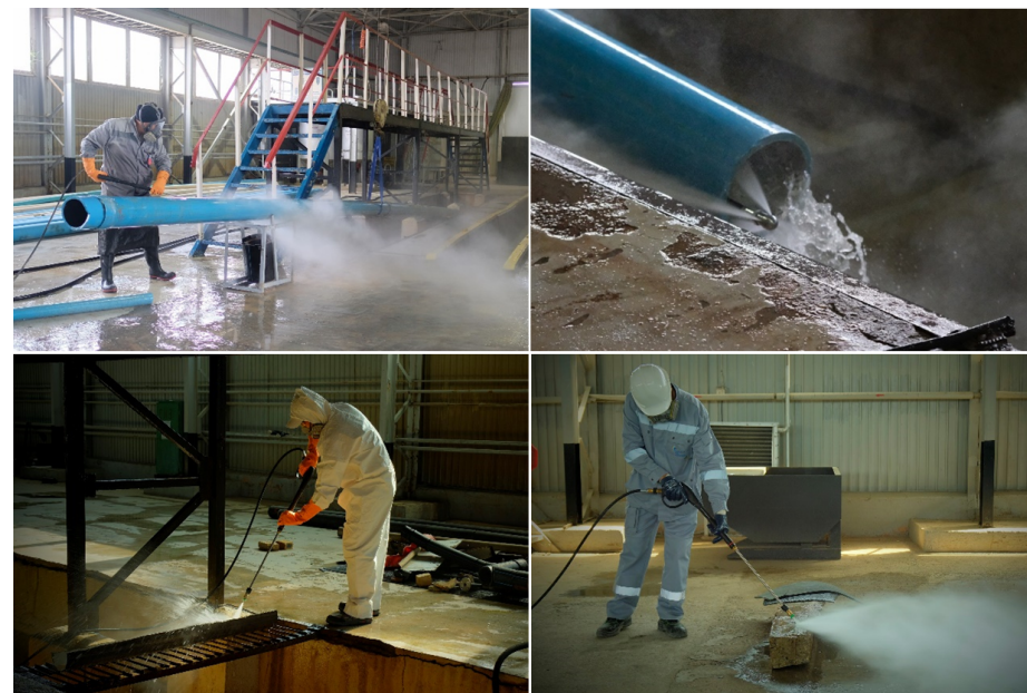
Рисунок 3. Дезактивация образцов гидродинамической машиной
