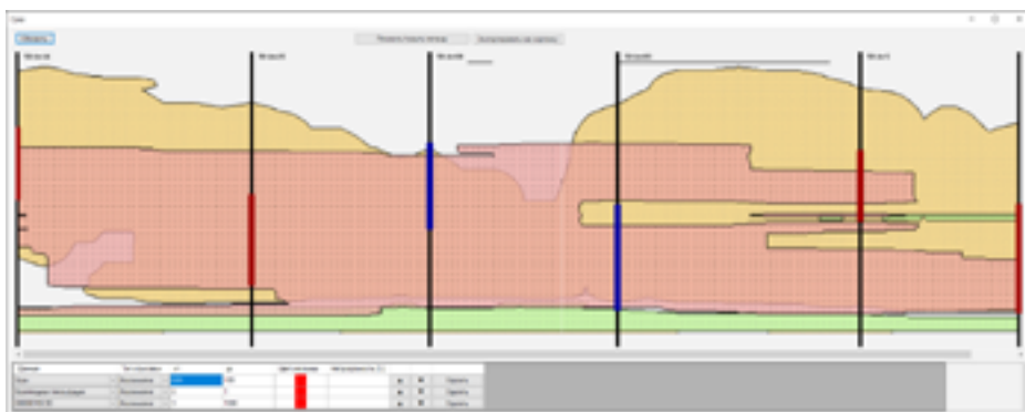
Рисунок 8. Распределение ВР на 160 день работы блока с минимальной концентрацией ВР 3 г/л (оранжевый). Поверх наложены контур минерала с содержанием выше 0,01% (кирпичный) и коэффициент фильтрации K_f ниже 1 м/сутки (зеленый)
