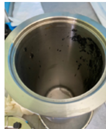
Рисунок 3. Образование черного налета и сажи на стенках сосуда при неправильном подборе массы бензойной кислоты
