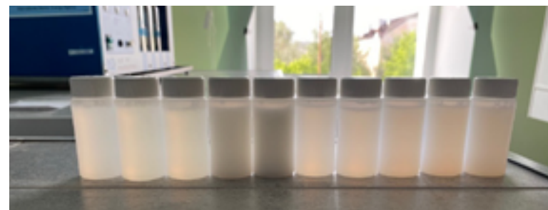
Рисунок 4. Счетные образцы с добавлением разных видов сцинтилляторов Ultima Gold (образцы №1-5), Ultima Gold LLT (образцы №6-10)
