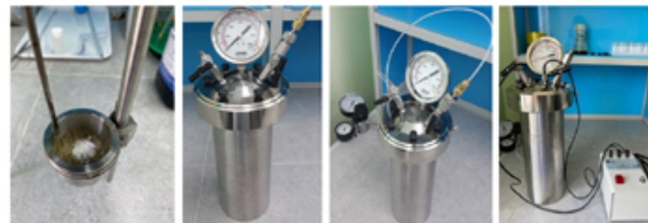
а) образец, помещенный в тигель б) сосуд в собранном виде в) заполнение сосуда кислородом г) сжигание образца
