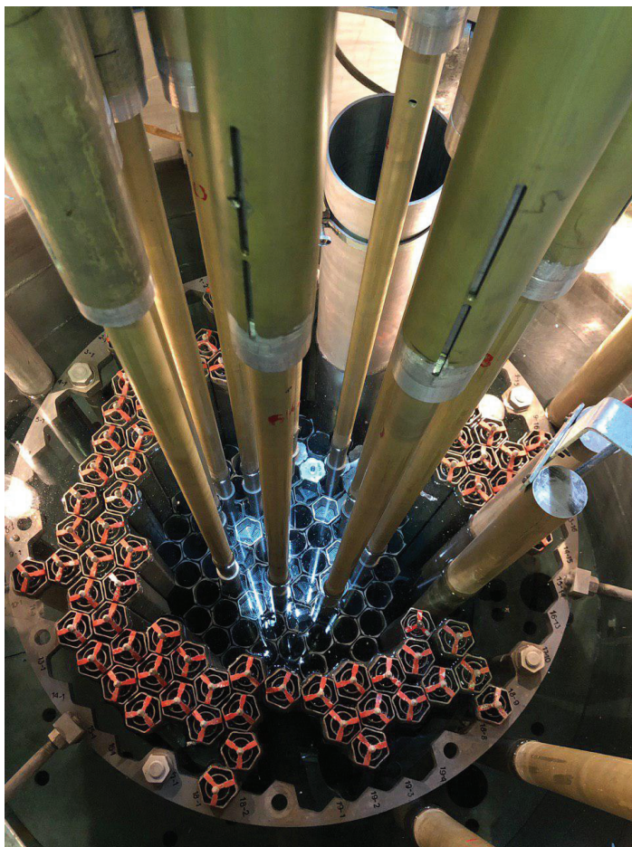
Рисунок 1. Активная зона критического стенда
