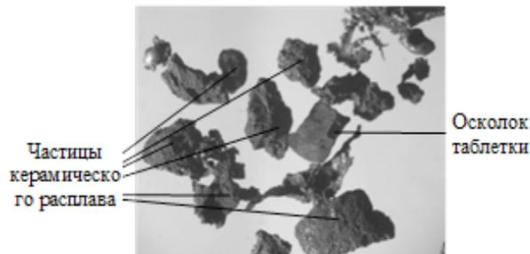
Рисунок 6. Характерные формы керамических частиц из ловушки ЭУ ID-2
