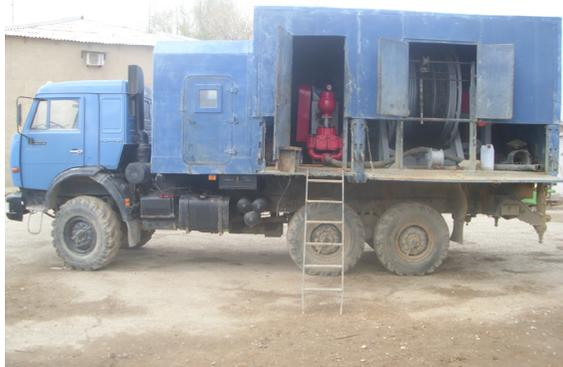
Передвижная модульная установка отчистки скважин ПМУОС
