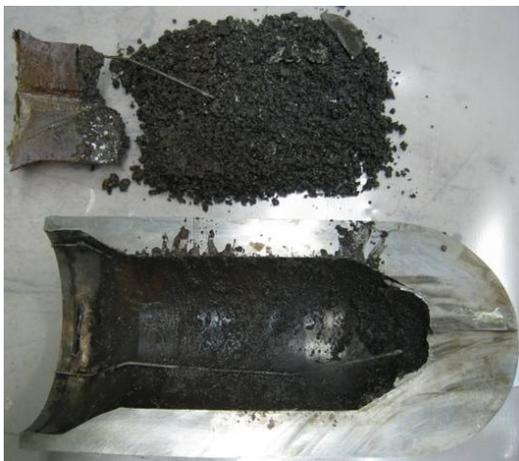
Рисунок 5. Внешний вид разреза ловушки устройства ID-2 и извлеченного из нее фрагментированного материала
