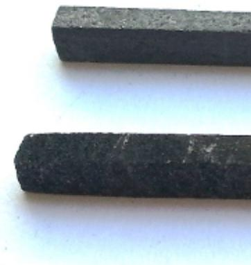
Рисунок 3. Образцы графита РГТ (верхний – до испытаний; нижний – после испытаний)
