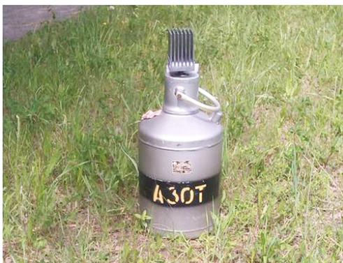
Рисунок 5. Устройство для криогенного вымораживания трития
