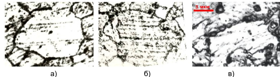
Рисунок 1. Микроструктура облученных образцов чехла ОТВС
