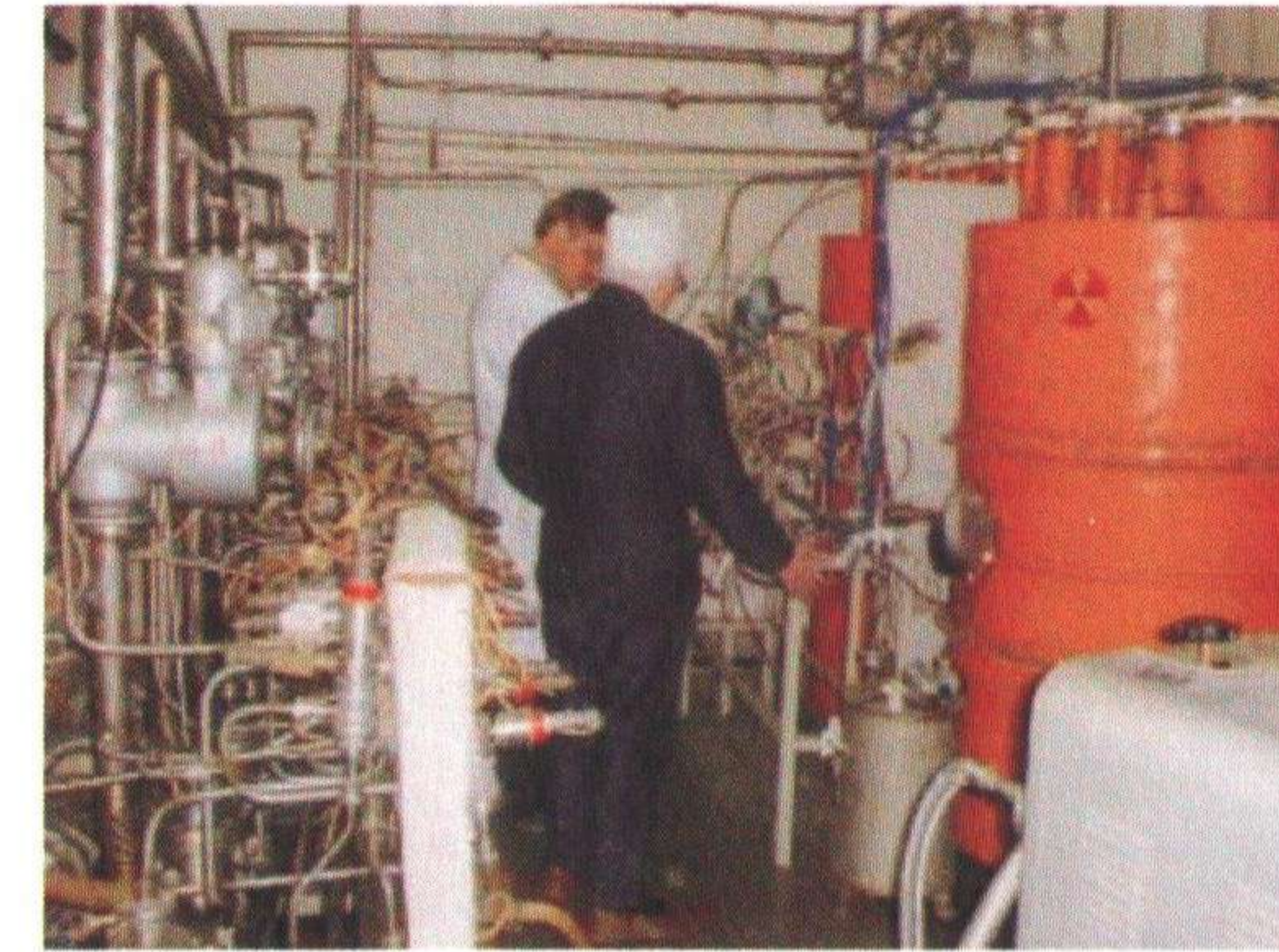
Рис. 3. Газовакуумные системы универсальной петлевой установки
