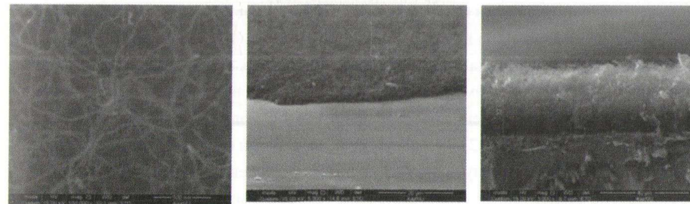
Рисунок 4 - Электронно-микроскопические снимки слоев УНТ на кремниевой подложке, полученных в водородной атмосфере при температуре 875°C, время синтеза 15 мин, увеличение x150000 (a), x5000 (b) и x3000 (c). Снимки сделаны при угле съемки 0° (a), 70° (b) и 90° (c).
